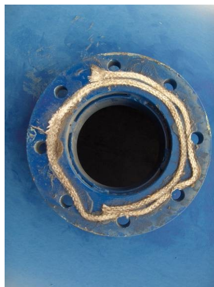
Esempio di tronchetti di prelievo da 4" flangiati
